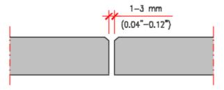
Figure 3.15 - Bevelled edge
